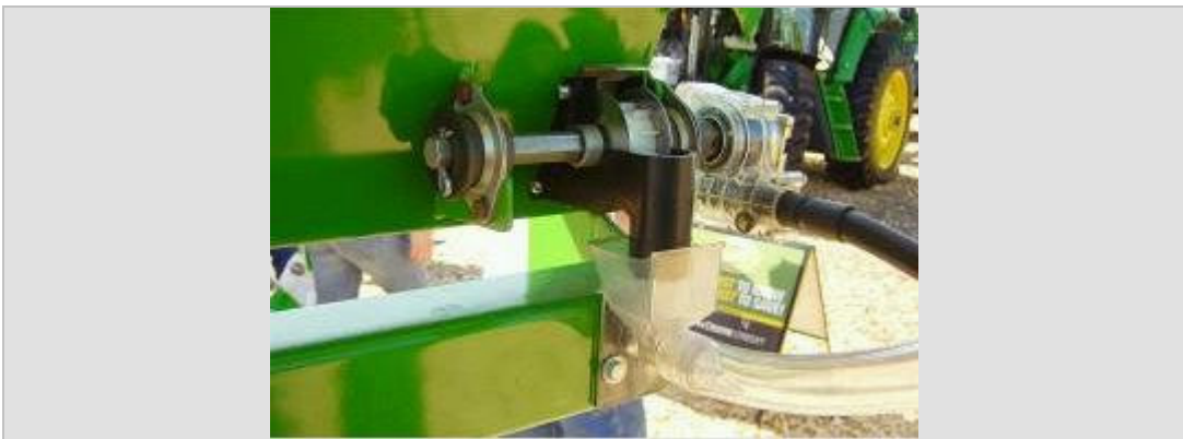
Imagen 4: Demo de funcionamiento del nuevo distribuidor a rodillo y tubo venturi de aire y manguera de traslado de la semilla hacia el cuerpo de siembra; este parece ser el futuro en Air Drill para la siembra de soja.
