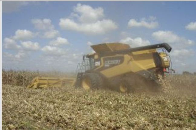
Figura 1. CAT Lexion (CLAAS), 590 R, con cabezal de maíz de 16 hileras a 0,76 m (12,6 m), con una capacidad de 80 toneladas/hora de maíz. Fue la máquina de mayor capacidad de alimentación en la dinámica dado que aventajó a la siguiente en un 33 % en el ancho de labor del cabezal maicero trabajando a idéntica velocidad de avance.
