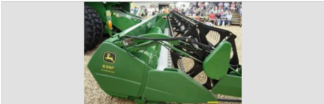
Figura 3. Cabezal John Deere Hydraflex serie 600 sojero, con nuevo flexible de movimiento neumohidraulico y nuevo sistema de corte de 2 x 2 con movimiento alternativo de 3,5 pulgadas.
