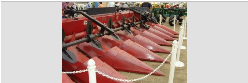
Figura 12. Kit para cabezales maiceros de la firma DG Padalle Reel para la recolección de maíces volcados.
