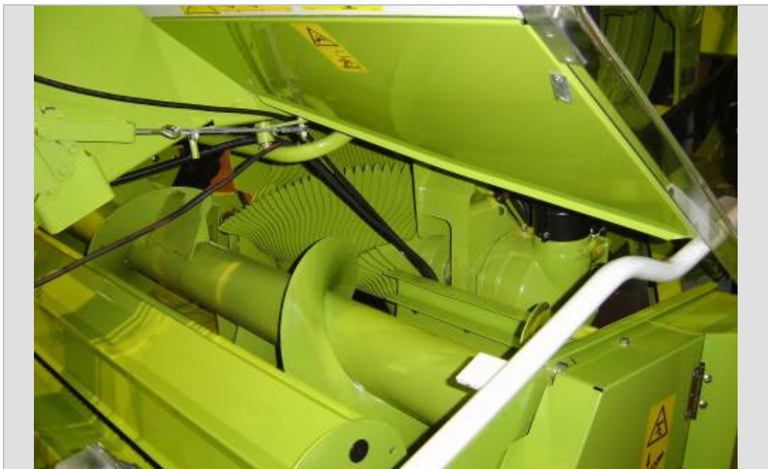
Imagen 52: Roto Cut de la enfardadora Claas. Corta el forraje en la medida que ingresa.
