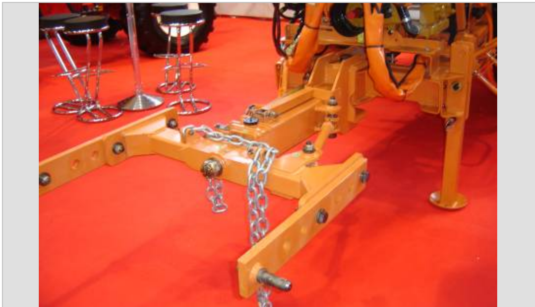
Imagen 59: Detalle del enganche de la Jacto Advance 3000 semimontado con brazo de posicionamiento del pulverizador.
