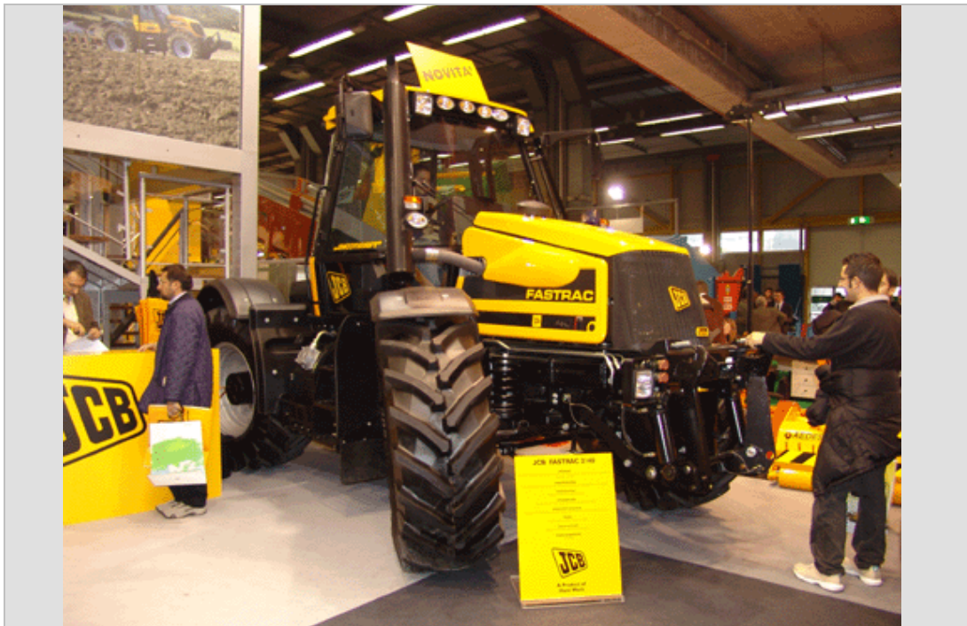
Imagen 67: FASTRAC: Tractor todo terreno JCB, con suspensión en las 4 ruedas, 4x4, freno a disco en las 4 ruedas, con ABS, 80 km/h de velocidad máxima y doble 3 puntos delantero y trasero, una constante en Europa.
