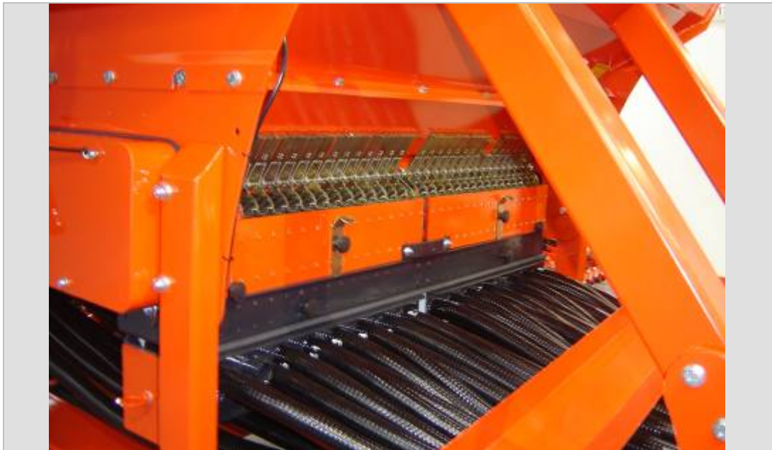
Imagen 62: Distribuidor mecánico y expulsión neumática (grano fino, tendencia observada en muchas marcas europeas, que reemplaza al Accord tipo copa).
