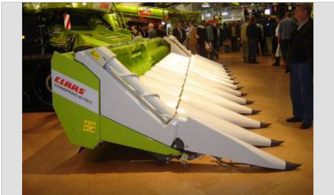
Imagen 24: Nuevo cabezal maicero Claas 12-75 C, con puntones y capot plástico con doble sinfín, con guía rotativa de plantas laterales, pero la gran novedad estuvo en sus rolos cónicos, de 4 y 6 caras progresivas. Esto provoca un aumento de velocidad progresiva; la planta ingresa y baja lenta; se produce el espigado y luego se acelera bruscamente evitando que el del tallo ingrese a la cosechadora (Inteligente el sistema); la planta de maíz es cónica, el rolo debe ser cónico; la planta, cuando todavía tiene la espiga, debe ser tratada con suavidad; luego tolera agresividad porque sólo resta bajarla.
