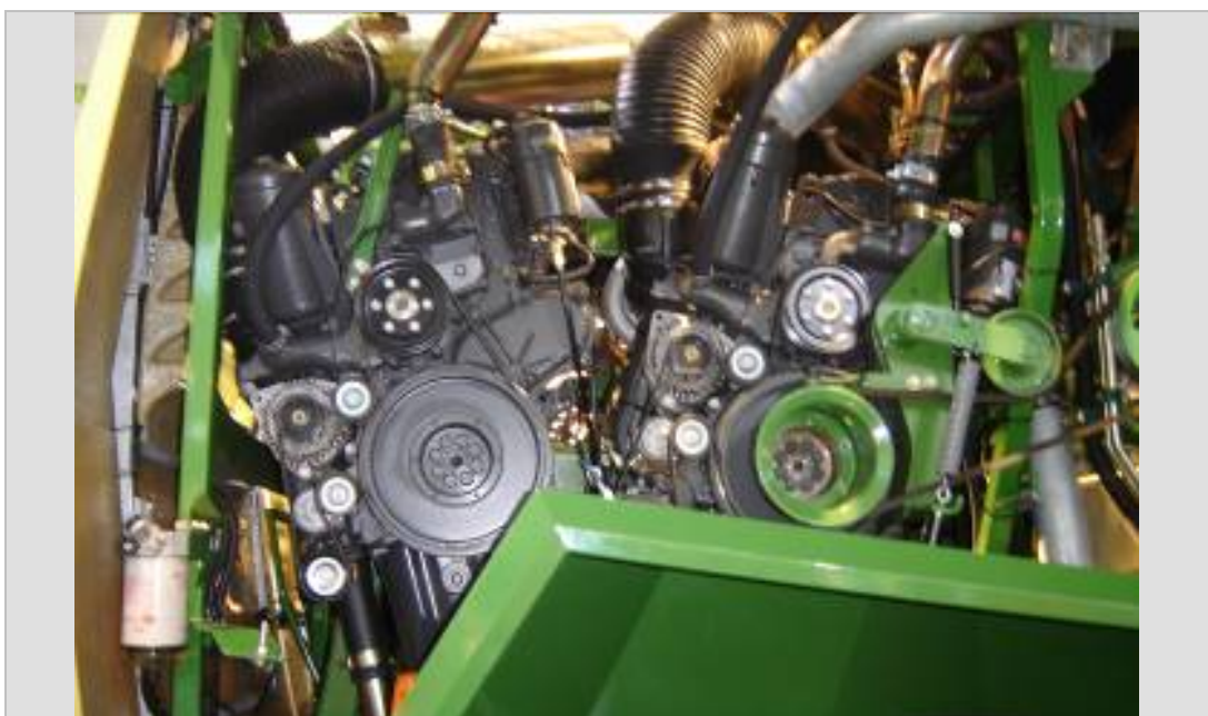
Imagen 42: La autopropulsada alemana KRONE BIG 1000 fue la novedad con potencia de 1.000 CV y 2 motores Mercedes Benz de 500 CV. La más grande del mundo.
