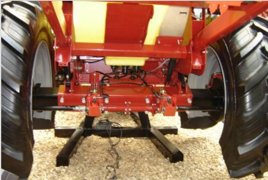
Imagen 57: Detalle de puente trasero de la pulverizadora Hardi de arrastre. Sistema de giro y freno de las ruedas traseras del Hardi Commander 3200 It (versión 2006)
