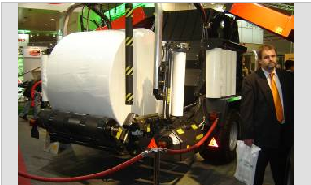
Imagen 44: Roto enfiadora No stop; no se detiene para atar ni para empaquetar: constituyen 3 procesos continuos.
