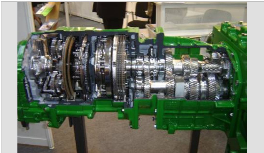
Imagen 68: Caja Power Ship por dentro. Esto es una constante en todos los tractores.
