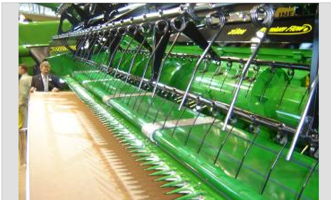
Imagen 31: Vista lateral del cabezal FENT/AGCO, equipado con alimentación por cinta y sinfín especial para la recolección de colza/canola.
