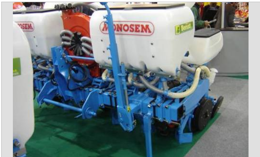
Imagen 66: Sembradora Monosem, fertilizador soplado por aire, "para imitar".
