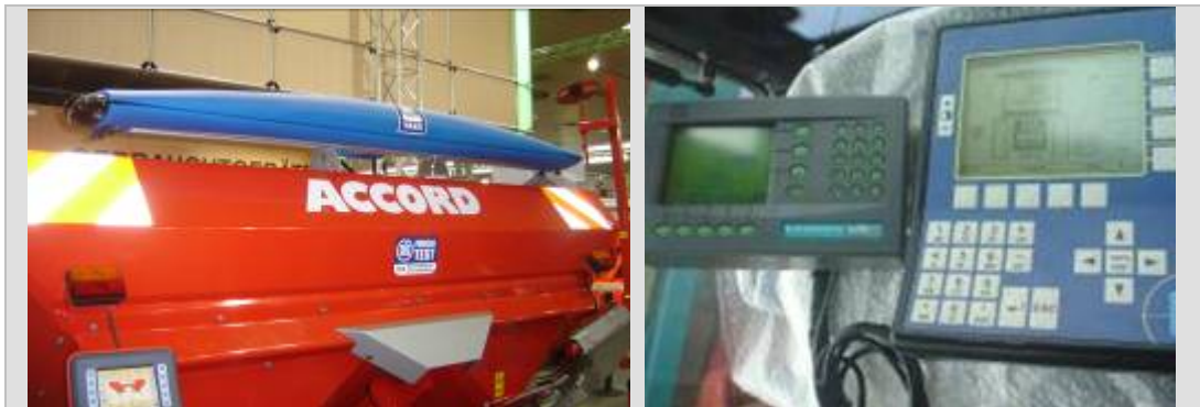
Imagen 9 y 10: N-SENSOR, ahora colocado en Fertilizadora, puede leer el índice verde y biomasa del cultivo. NOVEDAD 2005 N-Sensor Activo, pudiendo trabajar a cualquier hora del día.
