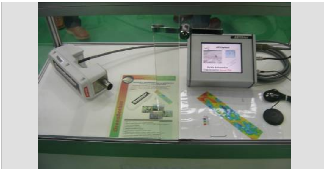
Imagen 11: Green Seeker. Biomasa e Índice Verde para aplicaciones diferenciales. 1 lector cada 90 cm. de barral. Sensor activo.
