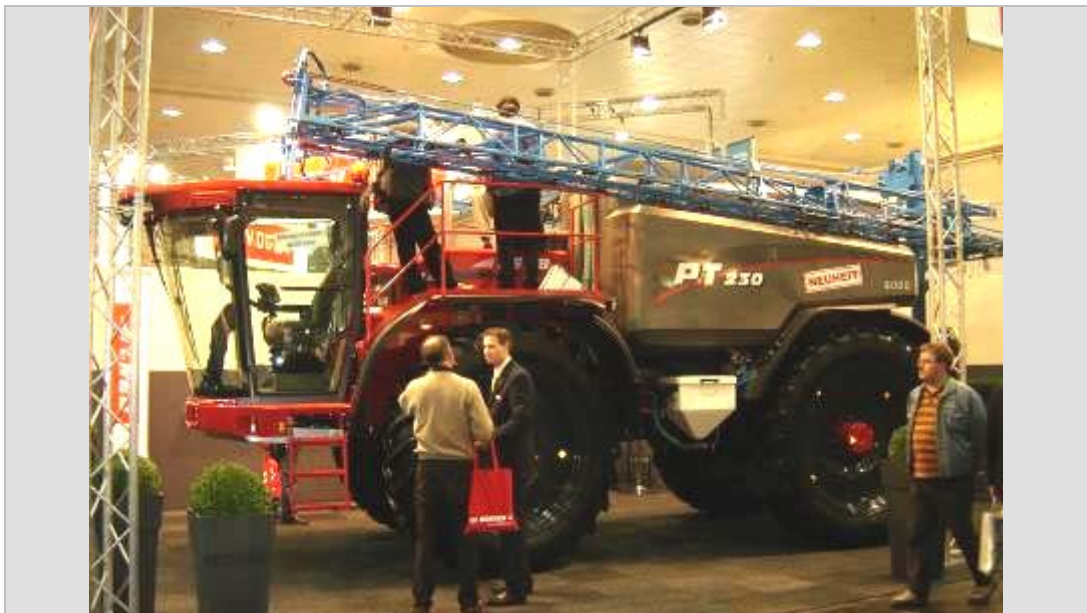
Imagen 61: Pulverizadora autopropulsada de 250 CV, con 5000 lt de capacidad de tanque, de acero inoxidable, barral de 36 m de ancho. Rodado de 46 pulgadas de diámetro. Transmisión hidrostática 4 x 4. Suspensión neumática. Esta es la tendencia europea en autopropulsadas. Gran capacidad de trabajo y mucha autonomía.
