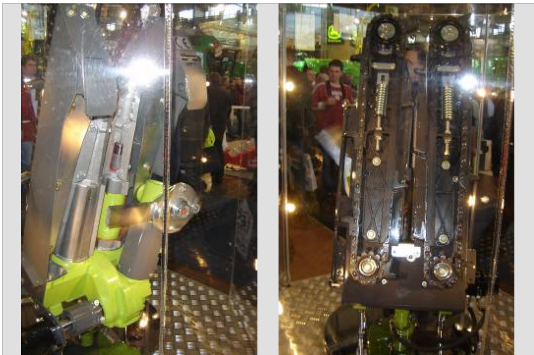
Imagen 26: El cabezal Claas posee picador rotativo de 2 cuchillas; también las cadenas alzadoras presentan guías de plástico, algo que en Argentina ya se viene probando con buenos resultados para reducir peso.
