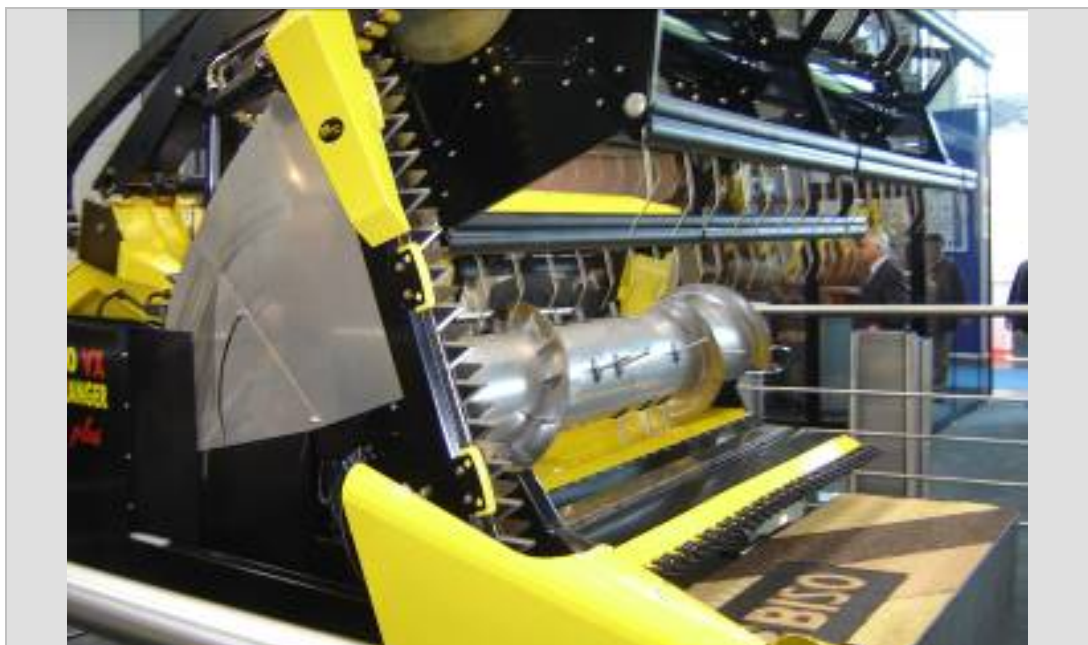
Imagen 28: Cabezal marca Biso, la vedette en cabezales. Nuevo cabezal flexible extensible hidráulicamente para colza/canola/soja/trigo. Cuchillas verticales y sinfín de acero inoxidable. Las adaptaciones se realizan en 2 minutos desde la cabina del operador.
