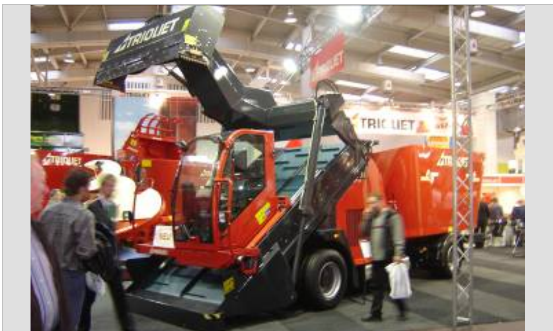
Imagen 34: Imagen de un típico mixer europeo autopropulsado con Freza de autocarga en la parte delantera, noria de carga y mezclador tipo vertical (tipo lavarropa) doble con noria de descarga reversible.
