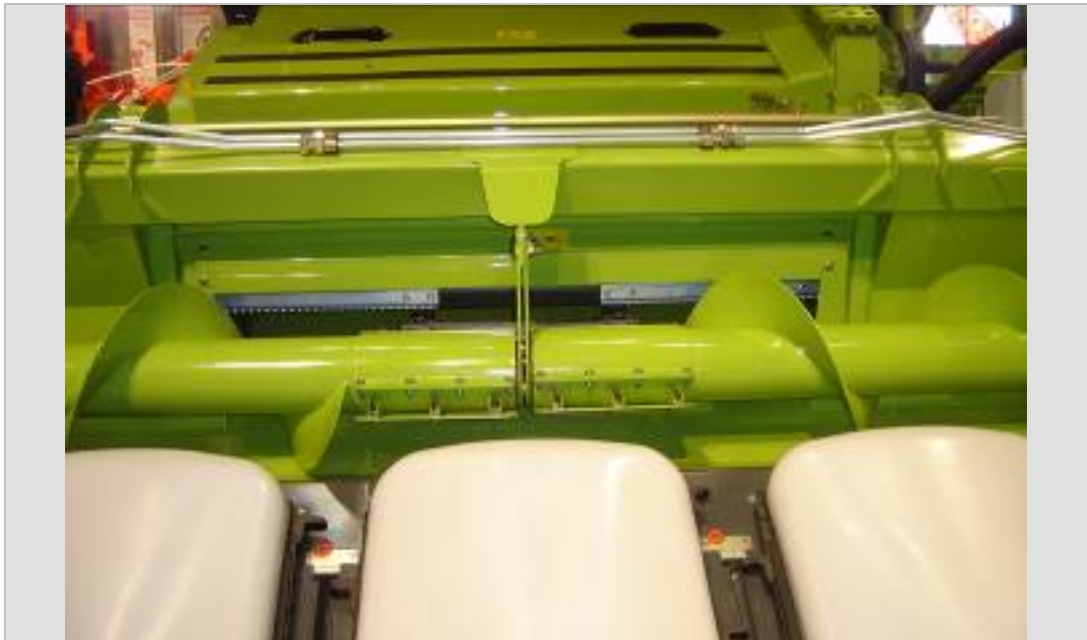
Imagen 25: Nuevo cabezal maicero Claas 12-75 C. Detalle del sinfín en su entrega y su apoyo central.
