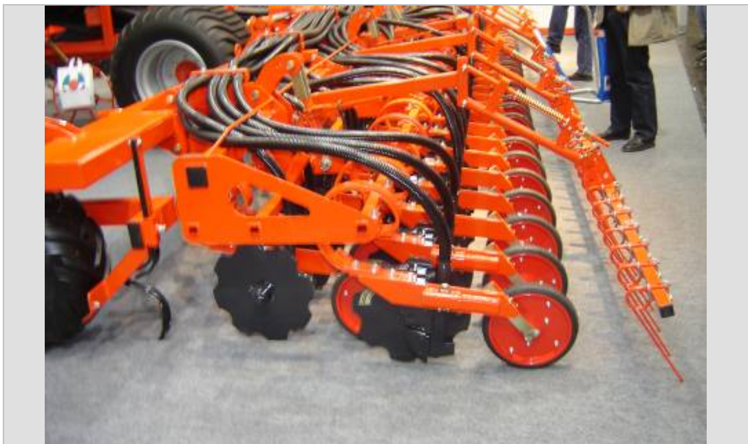
Imagen 63: Cuerpo de siembra de grano fino convencional que recibe por una manguera la semilla del distribuidor mecánico con expulsión neumática (grano fino, tendencia que reemplaza al Accord tipo copa). Detalle: los cuerpos están soportados por un fleje en 5 de alta elasticidad, lo que permite copiar el suelo casi como con un paralelogramo, simplicidad de construcción para sembradoras donde el suelo es preparado a medida para cada sembradora.
