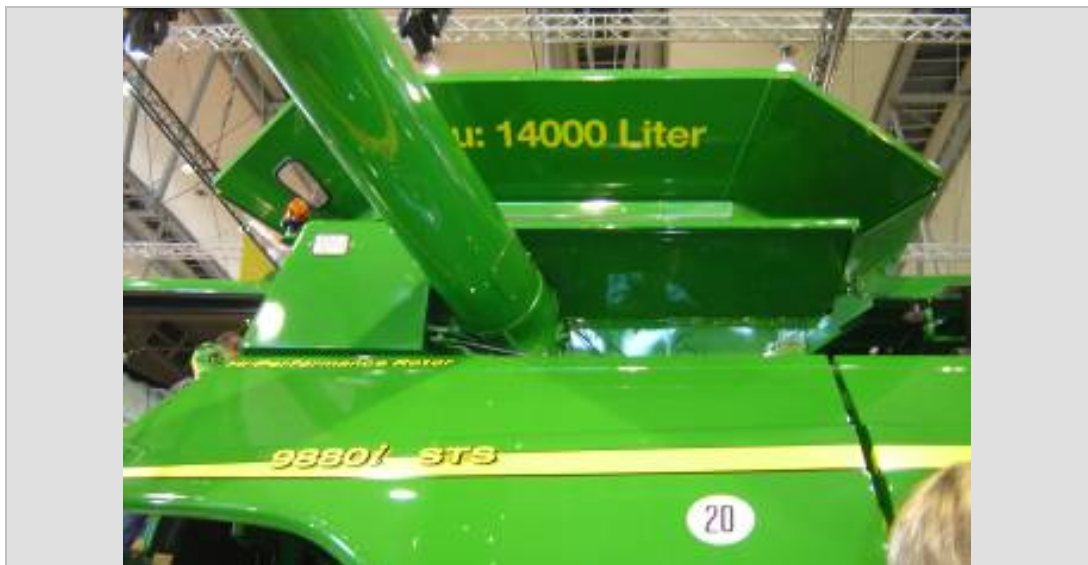
Imagen 20: Nueva Cosechadora John Deere 9880 i STS, 14.000 litros de capacidad de tolva. ¿Hasta dónde se seguirá creciendo? Rotor tipo bala de alta performance.
