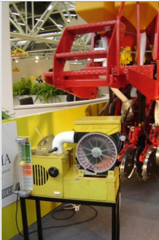
Imagen 65: Stand de Bertini en EIMA 2005. Distribuidor neumático por presión.
