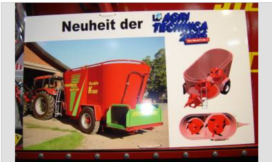
Imagen 35: Detalle de la cámara de mezclado vertical con cuchillas para procesar fibra larga.
