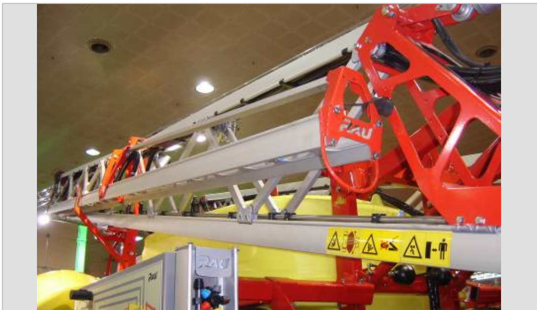
Imagen 60: Barrales totalmente de aluminio en la pulverizadora RAU. Prácticamente una tecnología aeronáutica de construcción de máquinas agrícolas.
