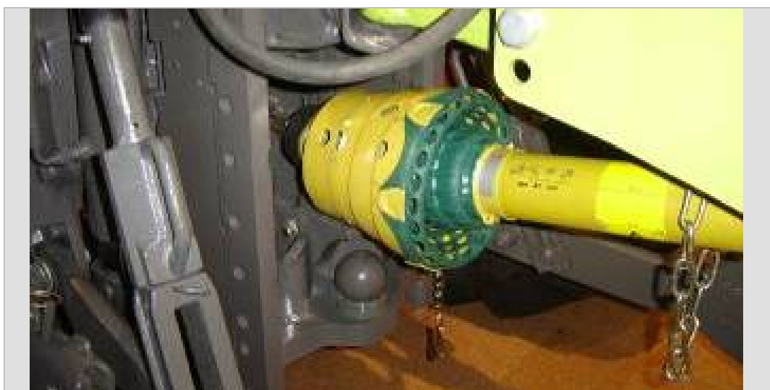
Imagen 54: Detalle de una buena protección de seguridad para barra cardánica y el enganche a bola para implementos parados.
