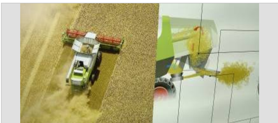
Imagen 16: Claas Flexion 600 con nuevo equipo de tratamiento de paja y granza. Medalla de innovación. Para imitar: un diseño muy similar fue desarrollado por un productor de Río III, Pcia. de Córdoba en el año 2001, sobre una Claas Lexion 480.
