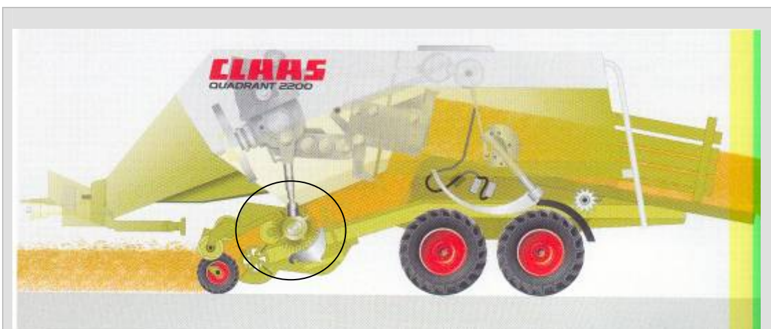
Imagen 51: Esquema de la ubicación del Roto Cut, el cortador giratorio con contracuchilla que secciona el pasto al ingresar.
