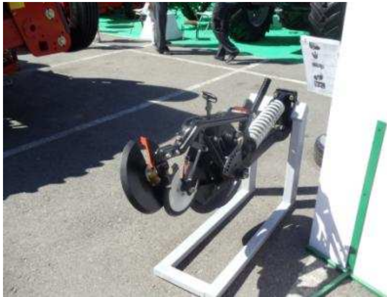
Cuerpo de siembra Abati Titanium, sembradora argentina de siembra directa con cuerpo monodisco introducida en Ucrania.
