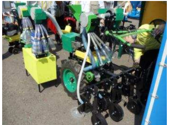
Máquina para pequeños productores. Sembradora Motocultur con dosificador neumático muy innovador, algo para ver y estudiar!!!. Sitio web: www.tractor-ast-dnepr.com.ua
