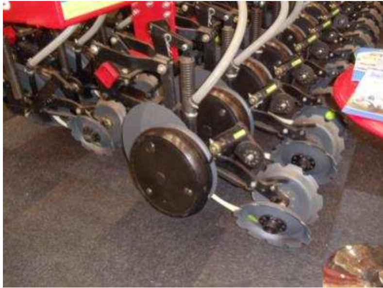
Detalle del cuerpo sembrador colocado en la sembradora ARPO COHO3/Pierobon.
