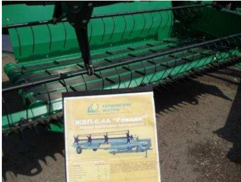
Segadora hileradora de arrastre para trigo, cebada, colza y pasturas. Plataforma de corte alternativo con acarreo por lona. Detalle: en lugar de la lona conocida de alto costo, se puede ver 4 cintas de menor costo. Innovación...para pensar! Sitio web: www.zhatki.com
