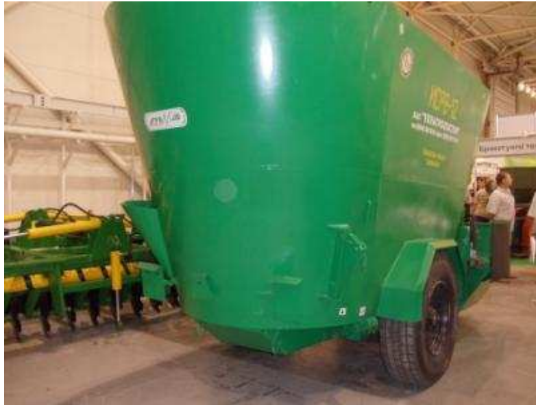
Mixer vertical de doble rotor de fabricación ucraniana. Largo, bajo y con rueda alta localizada al costado, marca una tendencia de cómo serán estos mixer en el futuro cercano!!!
