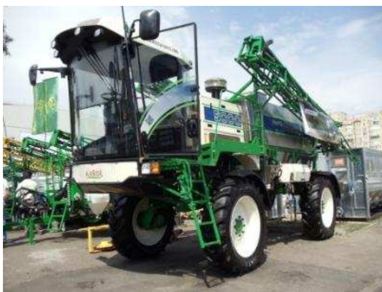
Competencia en pulverizadoras de fabricación local. Pulverizadora autopropulsada Air Ride 4x4 hidrostática, suspensión neumática, 5.000 litros de tanque, todo el equipamiento electrónico de pulverización y de autoguía.
