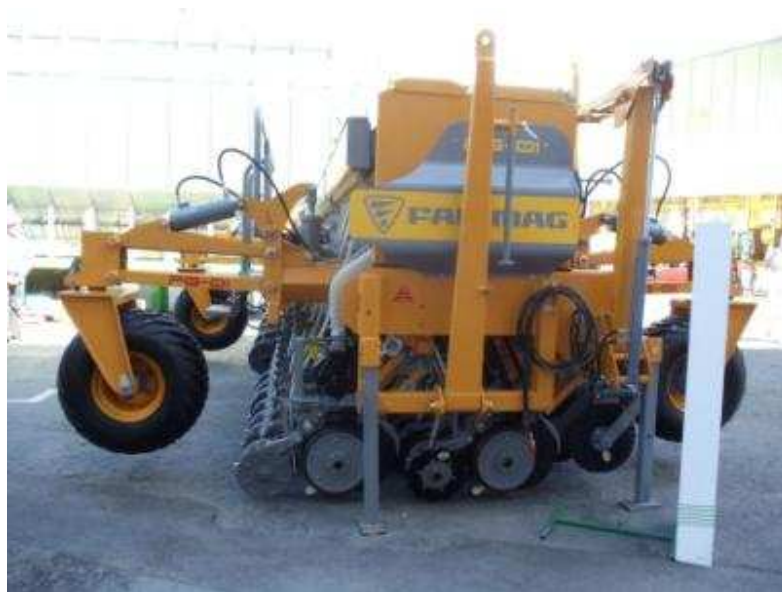
Sembradora Fabimag neumática de grano grueso (siembra directa). Buena presencia en el mercado ucraniano. El representante ucraniano de Fabimag también representa a la firma Semeato de Brasil.
