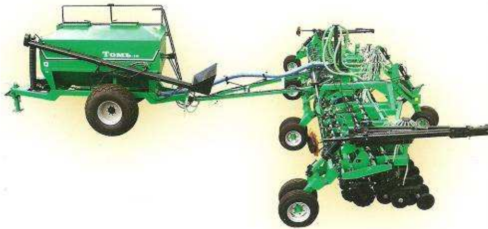
Sembradora ARPO versión Air Drill con tanque delantero, tipo copa, tiro de punta con disco turbo, doble disco y copiado trasero, marca una tendencia de cómo deberán adaptarse las sembradoras argentinas en el futuro cercano (versión de Europa del Este) con orientación triguera, de lo contrario se perderá competitividad.
