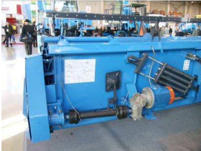
Cabezal de accionamiento totalmente eléctrico de la cosechadora experimental de origen ruso.
