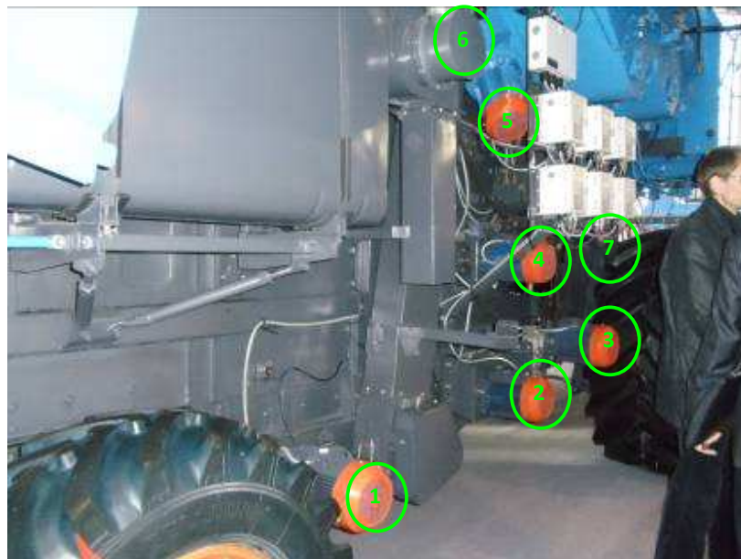
Vista lateral de la cosechadora de accionamiento electrónico donde se pueden ver los 7 motores eléctricos que accionan los diferentes componentes de la cosechadora. Agromach Holding y el Centro de Investigación (o.time.kzk de Rusia).
