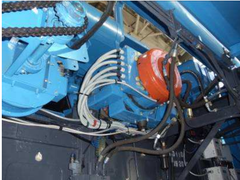
Cosechadora experimental Rusa totalmente eléctrica. Vista del generador principal que es accionado por el motor gasolero de potencia convencional.
