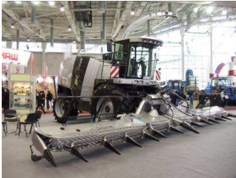
Fuerte presencia de picadoras autopropulsadas alemanas, en este caso una de Krone de 10 m. de ancho de cabezal maicero-sojero, 1.000 CV con 2 motores.
