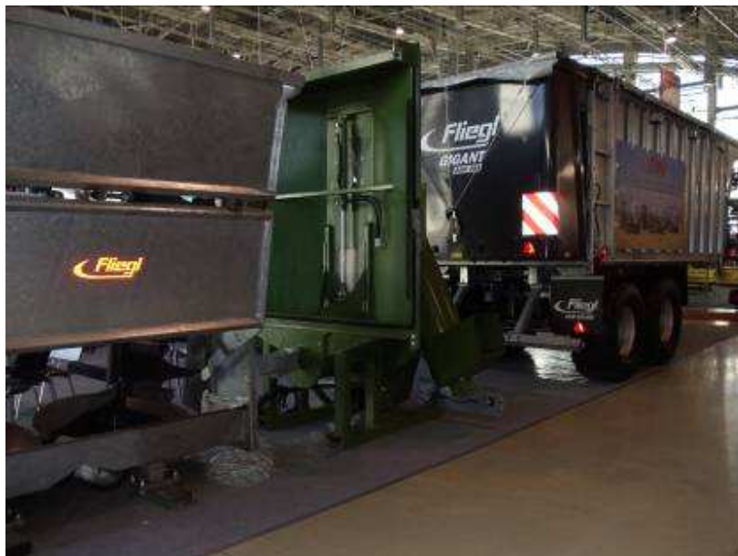
Carro silero compactador "Fliegl" ( www.fliegl.com ) de triple uso: carro silero compactador, grano y distribuidor de estiércol de alta eficiencia. Tres colas intercambiables que otorgan un triple uso a un acoplado muy innovador, que ya se conoce en Argentina y que sin duda está marcando una tendencia para seguir.
