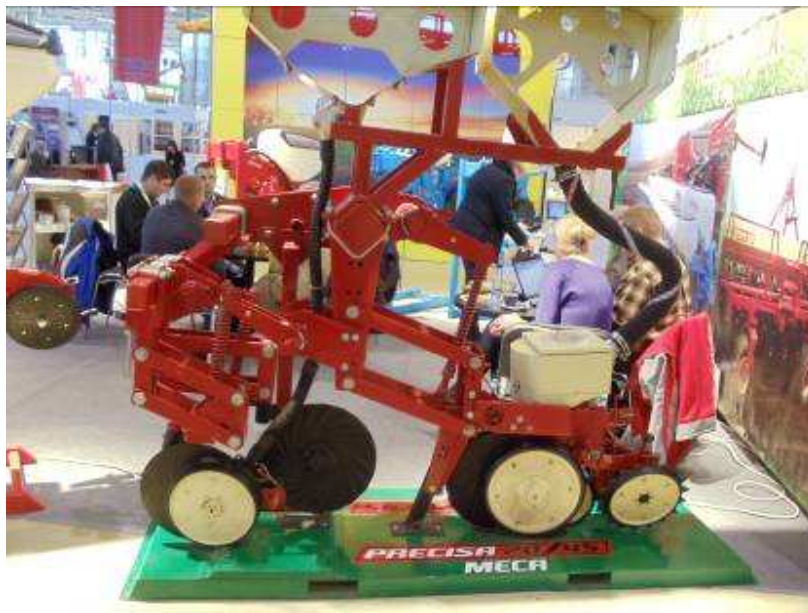
Corte de cuerpo de sembradora de Siembra Directa GIORGI (Argentina), quienes poseen dealer en Europa del Este y una presencia en Rusia de varios años.
