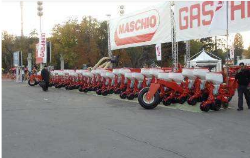
Sembradora neumática de 36 surcos a 70 cm de la firma italiana Gaspardo, sin fertilización para mínima labranza, no se adapta para siembra directa y constituye un parámetro de referencia, de lo que hoy busca el productor ruso.
