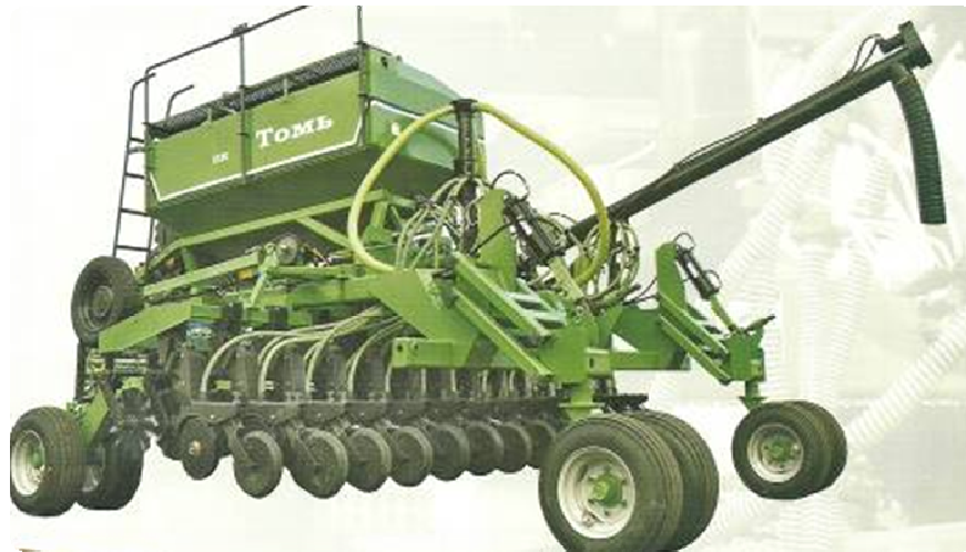
ARPO 27 hileras a 19 cm., 5.13 m de ancho, tolva 60/40 semilla fertilizante, abresurco en 2 planos, requerimiento de potencia 130 a 150 CV, precio competitivo y transporte tiro de punta.
