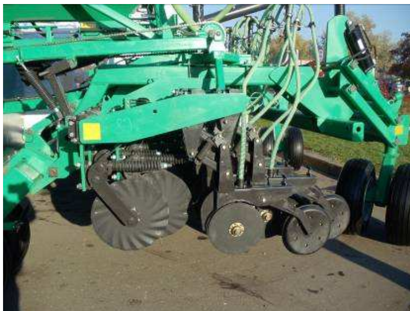
Detalle de la sembradora Rusa ARPO. Cuerpo de siembra de Siembra Directa con cuchilla turbo, cuerpo con paralelogramo, doble disco plantador y rueda tapadora de control de profundidad, muy sencillo para trigo. Diámetro del doble disco 43 mm., observar el detalle de fijación semi flexible de la cuchilla al bastidor, es evidente la inspiración de diseño con la Great Plain americana.
