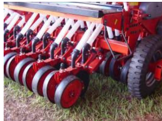
Figura 5. (izq.) Esquema mostrando las conveniencias funcionales de un tubo de bajada curvo, que acompañe la inercia de la semilla. (der.) Tubos de bajada telescópicos. Fuente: INTA Manfredi, 2006.
