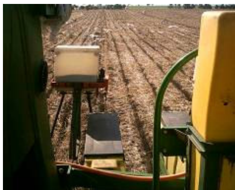
Figura 10. Imagen mostrando el trabajo de los barredores de rastrojo sobre un rastrojo de Trigo. Fuente: INTA Manfredi, 2006.
