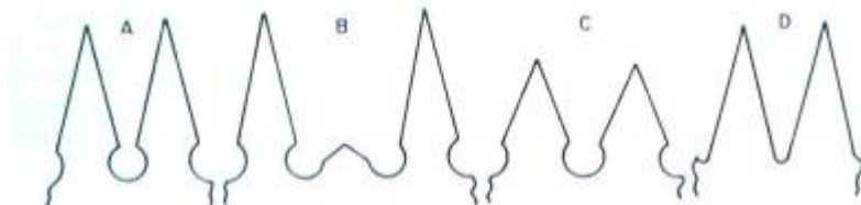
Figura 9. Diferentes diseños de dientes del peine desgranador ensayados por el Silsoe Research Institute del Reino Unido.
