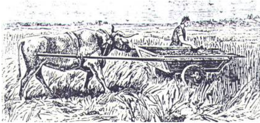
Figura 1. Sistema Gallic Vallus de cabezal desgranador, descrito por primera vez por Plinio alrededor del año 70 DC.
