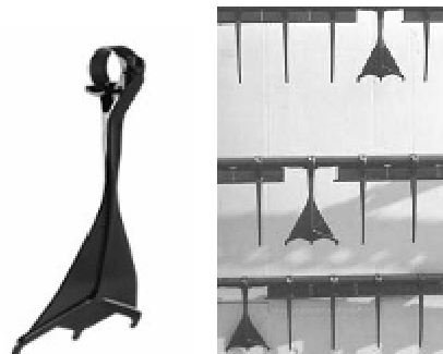
Figura 7. Diente de molinete tipo "pata de ganso" para trigos de bajo porte.
