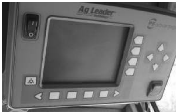
Figura 3. Monitor de rendimiento PF Advantage (Ag Leader). En este caso, el monitor con la tecla Tn/hs , puede ser de utilidad práctica para aumentar y disminuir la velocidad de avance, manteniendo el flujo de grano constante frente a variaciones de rendimiento del cultivo o al alcanzar diferentes ambientes.
