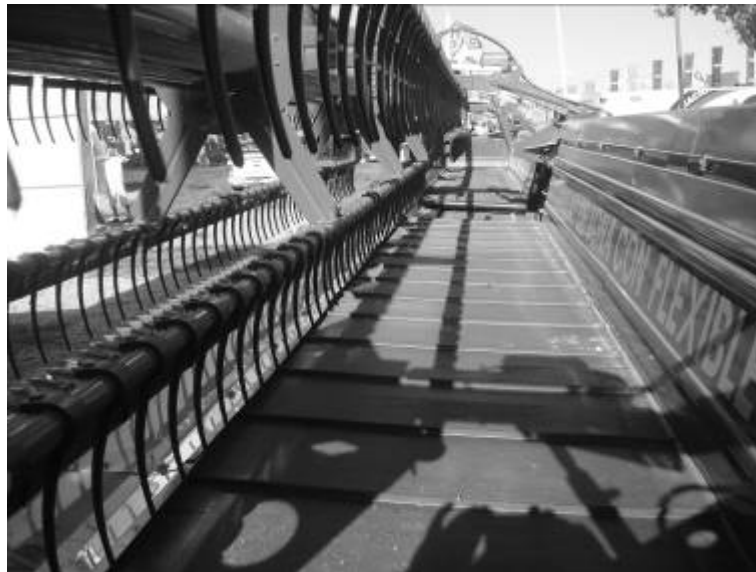
Figura 4. b y c. Cabezal de Soja/Trigo, de 40 pie de ancho de corte con alimentación por lonas, suspendido sobre dos ruedas con suspensión neumáticas. Año 2009, Empresa Piersanti Plataformas.
