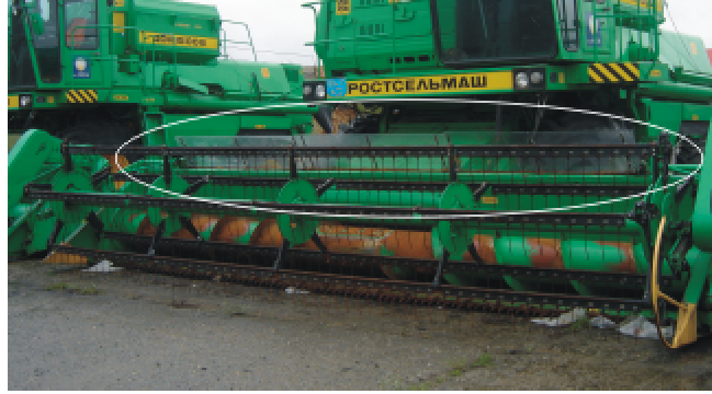
Figura 15. Pantalla de acrílico colocada en cabezal de origen ruso, para evitar el voleo de plantas y de espigas de trigo/soja, fuera del cabezal.
