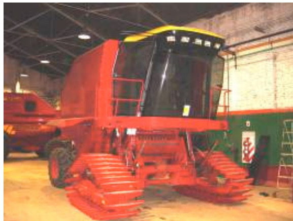
Figuras 18. Cosechadoras con orugas de metal tipo arrocera de buena prestación para situaciones de cosecha con agua en superficie.
