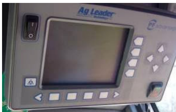
Figura 7. Monitor de rendimiento PF Advantage (Ag Leader). En este caso, el monitor con la tecla Tn/hs , puede ser de utilidad práctica para aumentar y disminuir la velocidad de avance, manteniendo el flujo de grano constante frente a variaciones de rendimiento del cultivo o al alcanzar diferentes ambientes.
