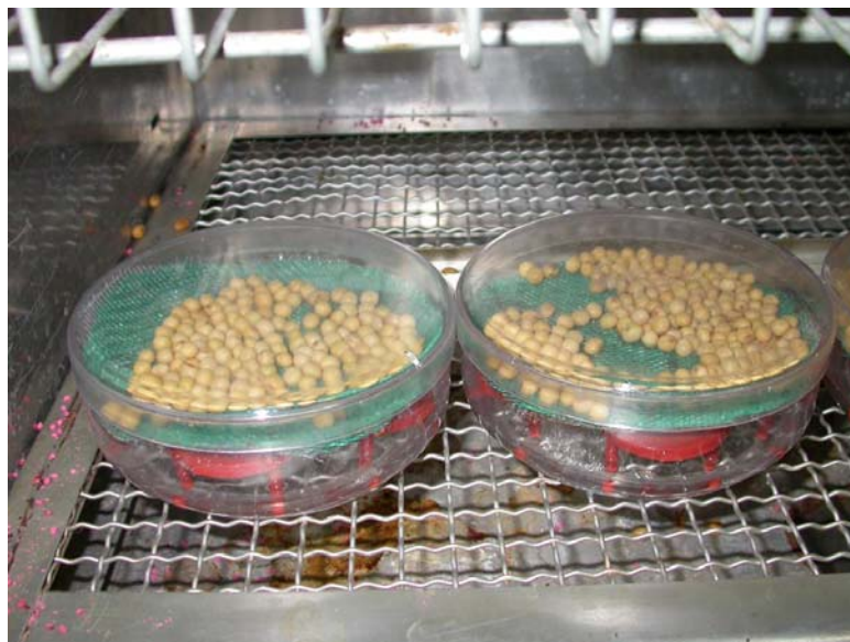
Foto 1. Mini cámaras de acrílico para la Prueba de Envejecimiento Acelerado
