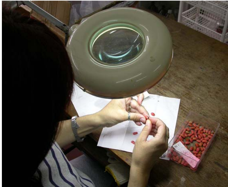
Foto 4. Evaluación de Vigor mediante la Prueba Topográfica por Tetrazolio
