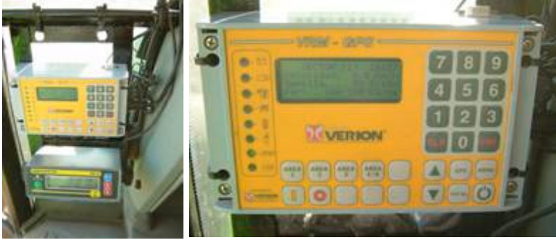
Fig 3: Ubicación del monitor Verion (arriba) y monitor de siembra Agrometal (abajo), en la cabina del tractor.
