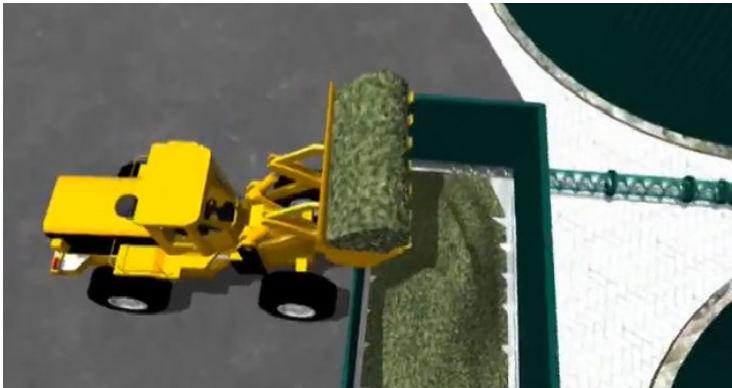
Pala mecánica alimentando el deposito racionador de sustrato solido al tanque digestor.
