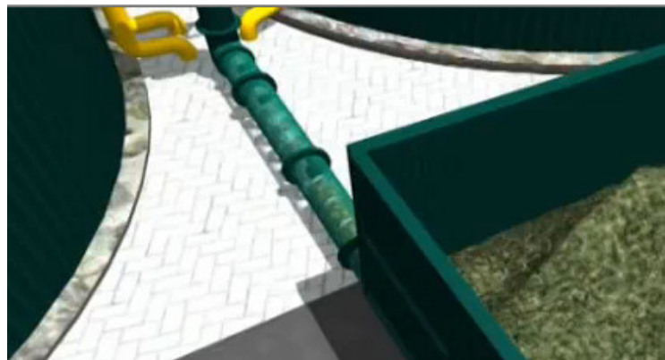
Conducto de tornillo sinfín que transporta el sustrato solido al tanque
