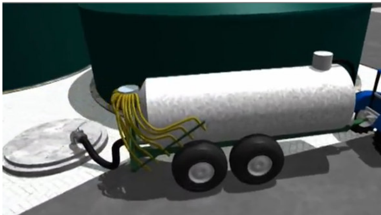
Descarga de los residuos líquidos en la cisterna de almacenamiento.
