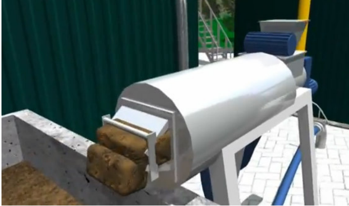
Separadora de fuerza centrífuga para extraer los sólidos de lo que se constituirá en fertilizante líquido.
